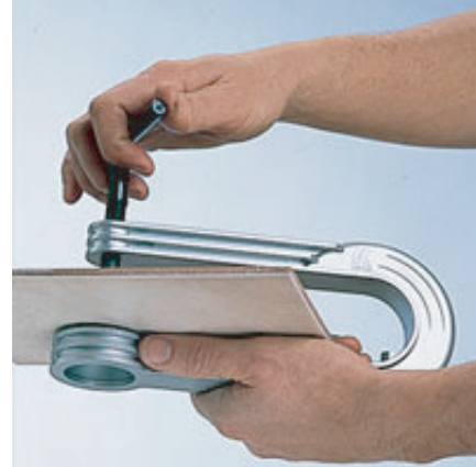
2. Wand- oder Bodenfliese so einlegen, daß die glasierte Oberfläche der Fliese durch die Öffnung sichtbar ist. Dann mit der Spindel anziehen.
