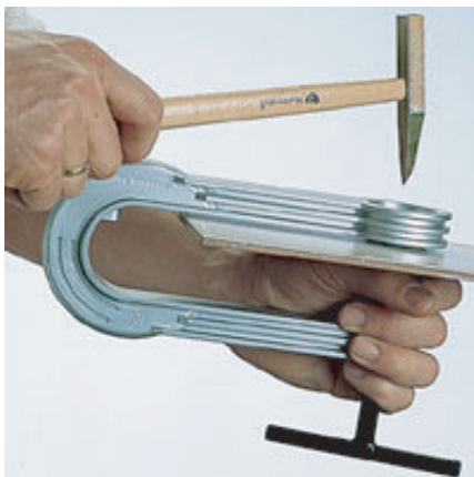
3. Schlagen Sie das Loch mit dem Fliesenhammer aus.
