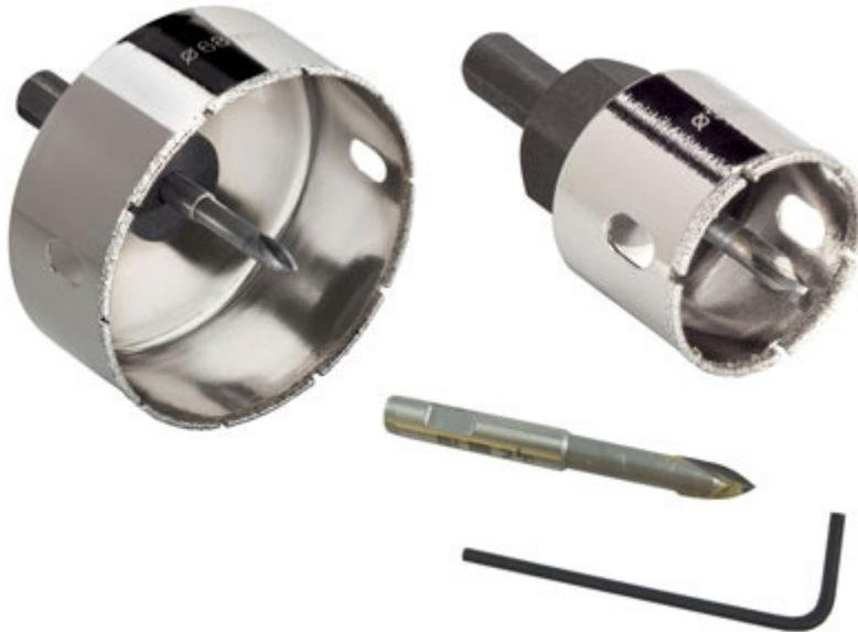
**Unsere hochwertige Profi-Diamantbohrkrone ist mit einem speziellen und einzigartigen Hartmetall-Zentrierbohrer ausgestattet. Sie bohren punktgenau und individuell in Wand- und Bodenplatten, Feinsteinzeug (Abriebhärt 4), Marmor und Granit.**
